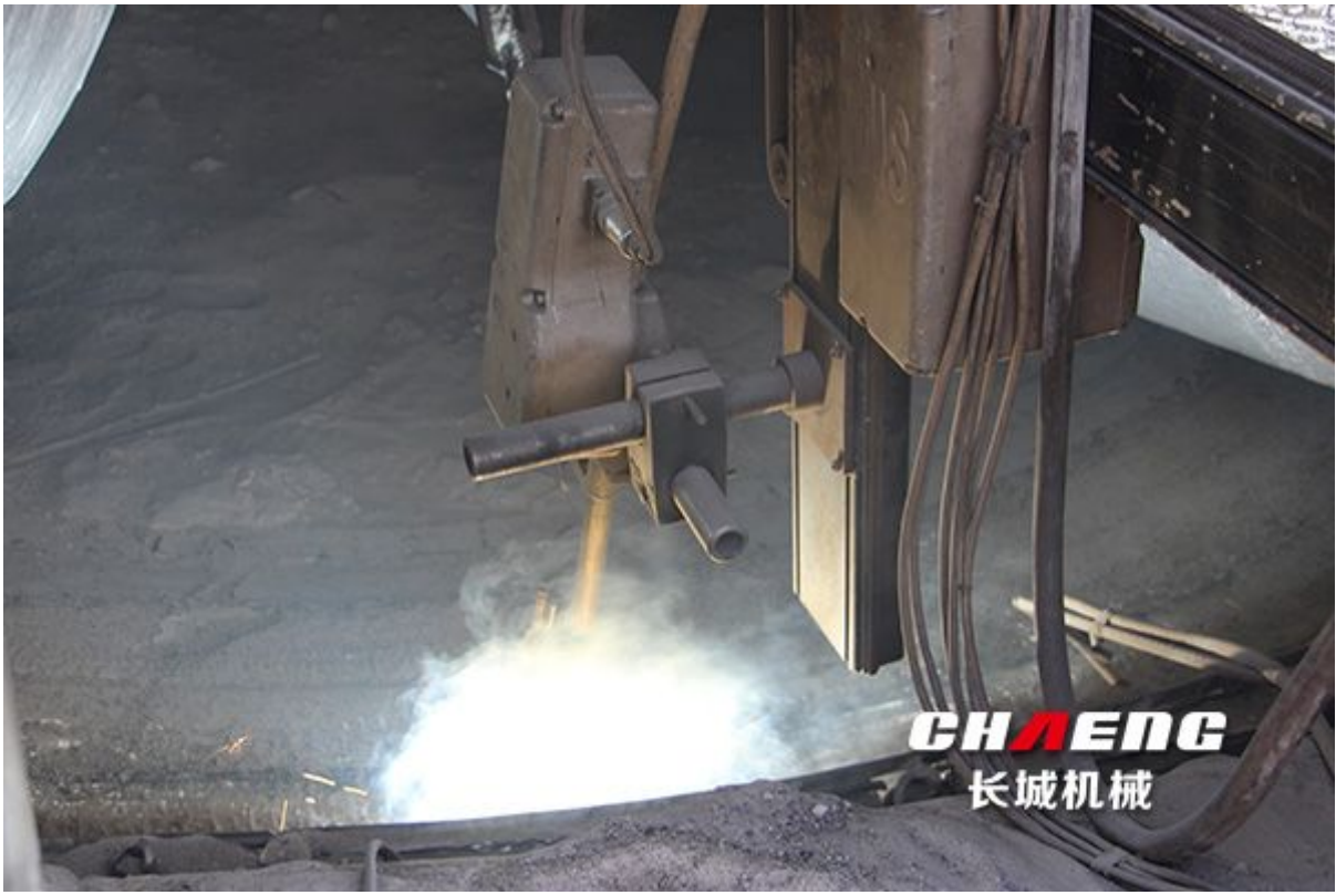
图：长城机械工人正在为客户进行在线堆焊
